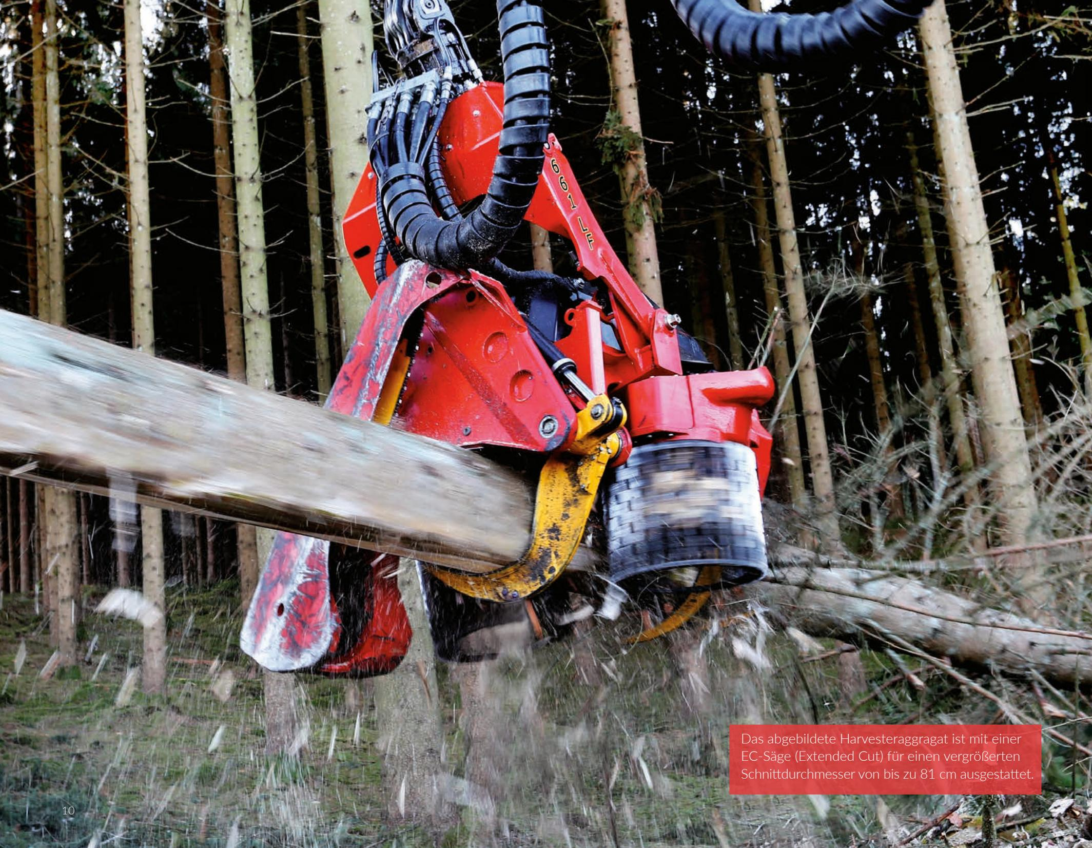
Das abgebildete Harvesteraggrat ist mit einer EC-Säge (Extended Cut) für einen vergrößerten Schnittdurchmesser von bis zu 81 cm ausgestattet.
