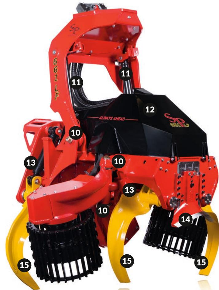
und durch Drehverschraubungen mit der Ventilbank verbunden. Dies garantiert höchste Strapazierfähigkeit und längste Lebensdauer, sie sind ausserdem mit robusten Hauben abgedeckt.
