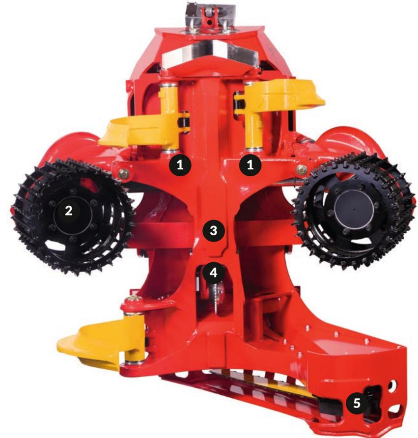
1. Für die höchste Messgenauigkeit ist die Durchmessermessung mit den beiden oberen Astmessern verbunden. Für optimalen Schutz und die längste Lebensdauer sind die berührungsfreien Durchmesserfühler im geschlossenen Stahlgehäuse montiert und befinden sich strategisch im Rahmeninneren.
