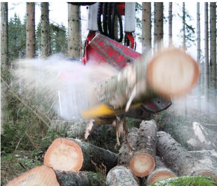
SPs QuickCut sorgt in Kombination mit der bärenstarken Sägeeinheit SUPERCUT100 für eine Minimierung der Ablängrisse.
