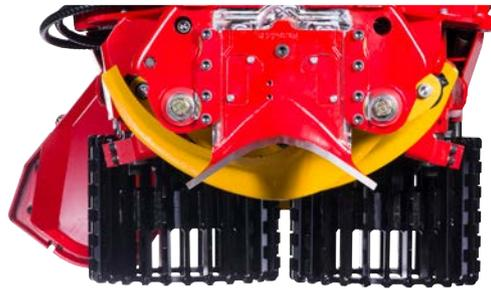
2. Aufgrund des Proportionaldrucks arbeitet das Aggregat automatisch mit dem korrekten Stammdurchmesser. Somit minimieren sich Energieverbrauch und Verschleiß. Unterschiedliche Einstellungen für verschiedene Baumarten steigern die Produktion und minimieren die Stammschäden.
