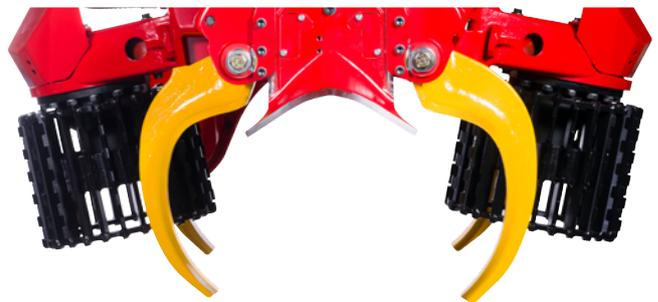
3. LogHold ist eine Weiterentwicklung des Proportionaldrucks. Damit lässt sich der Astmesserdruck am Stamm senken, ohne dass die Gefahr dafür besteht, dass der Stamm herausfällt. Droht der Stamm herauszufallen, steuert LogHold den Messerdruck so, dass der Stamm die korrekte Position beibehält. Wie stark sich der Durchmesser erhöhen darf, bevor LogHold reagiert, lässt sich im Steuersystem einstellen. Es sind keine zusätzlichen Geber oder Sensoren erforderlich.
