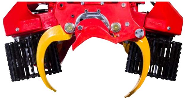
3. LogHold ist eine Weiterentwicklung des Proportionaldrucks. Damit lässt sich der Astmesserdruck am Stamm senken, ohne dass die Gefahr dafür besteht, dass der Stamm herausfällt. Droht der Stamm herauszufallen, steuert LogHold den Messerdruck so, dass der Stamm die korrekte Position beibehält. Wie stark sich der Durchmesser erhöhen darf, bevor LogHold reagiert, lässt sich im Steuersystem einstellen. Es sind keine zusätzlichen Geber oder Sensoren erforderlich.
