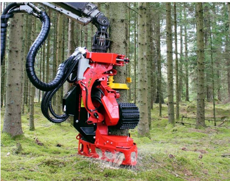
Bei SP 461 LF handelt es sich um ein kleines Aggregat mit großen Fähigkeiten, das aufgrund des Niedrigreibungsprinzips (LF-Prinzips) auch eine größere Durchforstung in den Griff bekommt.
